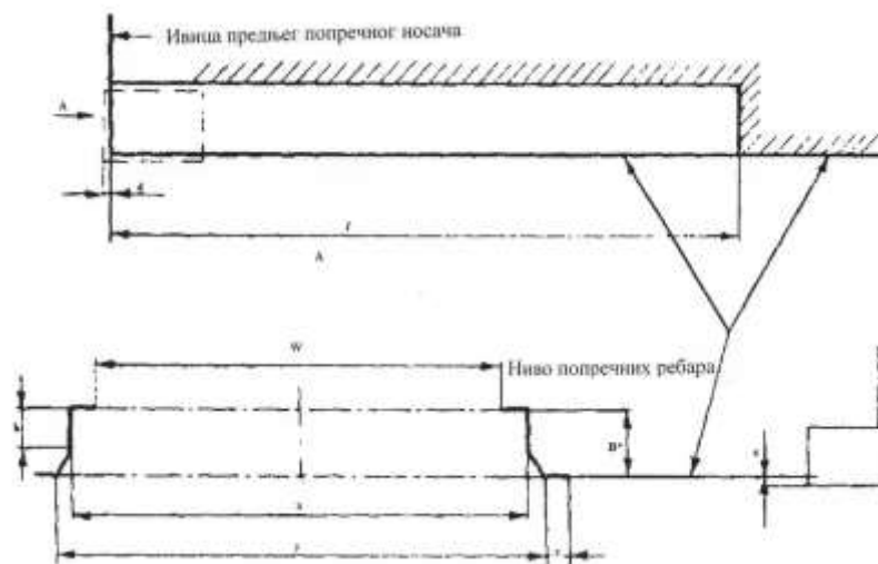
Слика 18.14 Распоред и димензије изреза за хватаче типа „гушчји врат”
